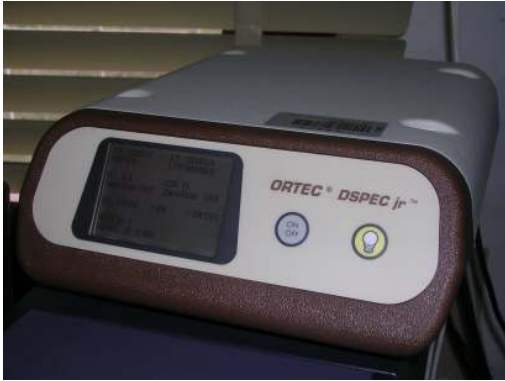
Figure 9: DSP module (ORTEC)
