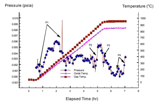
Fig. 5. TDMS pressure-temperature data for sample S'.
