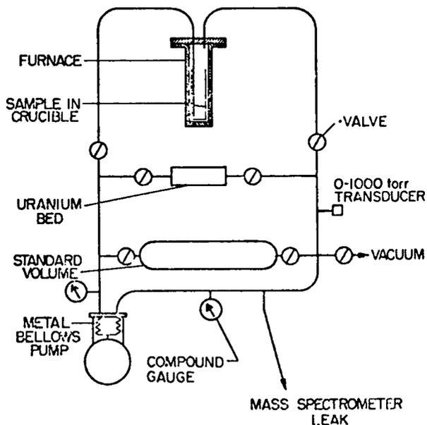
Fig. 1. Circulation apparatus.
