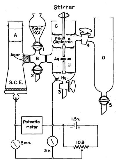
ELECTRICAL CIRCUIT FOR ELECTROCHEMICAL REDUCTION OF URANIUM FOR Procedure 12.
